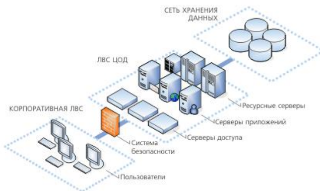
Рис.1. Типовая структура центры хранения и обработки данных
